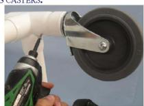
□ SECURE CASTERS USING ½" RETAINING SCREWS.
