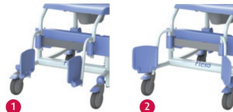
Beide Fußplatten müssen weggeklappt werden, wenn der Klient sich in den Stuhl setzt. Dazu klappen Sie die Fußplatten (1) hoch oder drehen beide Stützen (2) zur Seite. Achten Sie darauf, dass der Klient beim Transport mit beiden Füßen auf den Fußplatten ruht.
